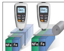
Folyo ve kaplama kalınlığının ölçülmesi
